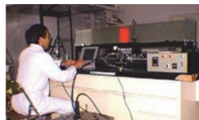
写真2 レーザー網地による魚群行動制御装置。長型水槽内の赤い部分がレーザー光で作成した網目模様。
